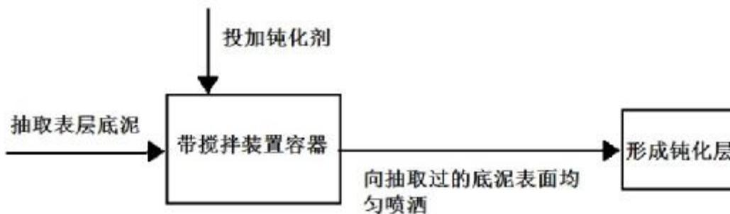
图 5.3-1 抑制底泥处理流程图
